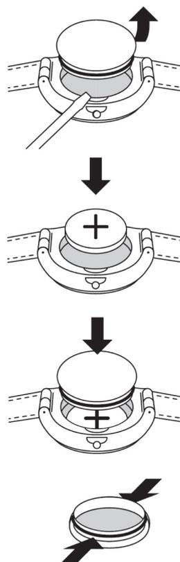
1. Осторожно откройте пластмассовую крышку с помощью небольшой отвертки.
