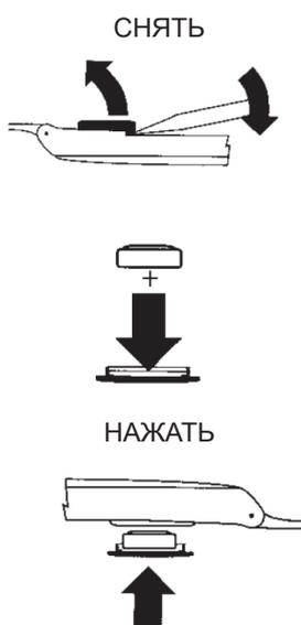
Осторожно откройте батарейную крышку с помощью небольшой отвертки. Установите батарею в батарейную крышку значком (+) вниз.
